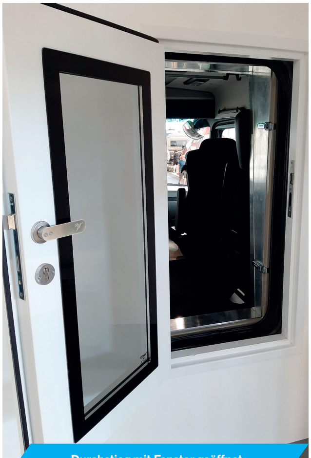
Durchstieg mit Fenster geöffnet
