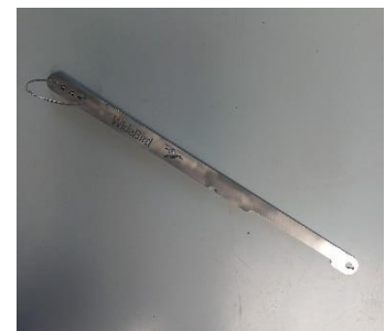
Abbildung 10 Ein Dachlukezieher, um das Fenster zu schließen, wenn Sie es aufgrund seiner Höhe nicht direkt mit der Hand erreichen können (nicht im Lieferumfang enthalten).
