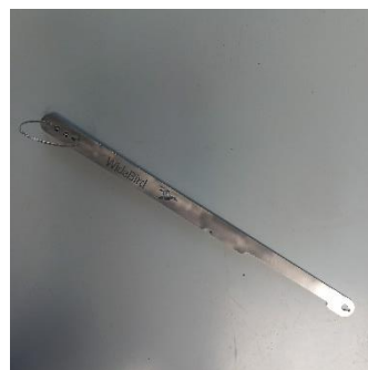
Afbeelding 10 Een dakraam trekker, om het raam te kunnen sluiten als u er met de hand door de hoogte niet direct bij kan (wordt niet standaard meegeleverd).
