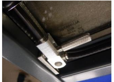
Abbildung 12 Der Gasfederhebel, mit dem Sie das Fenster weiter öffnen können.
