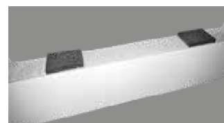
Afbeelding 4 Rubber strookjes onderin de uitsparing om het raam juiste hoogte te houden tijdens montage.
