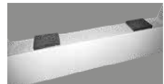
Afbeelding 4 Rubber strookjes onderin de uitsparing om het raam juiste hoogte te houden tijdens montage.
