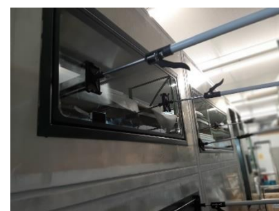
Afbeelding 7 Het raam wordt tijdens het droogproces in de wand gedrukt door steunen.
